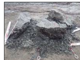
写真-2 スレーキング進行状況 （露岩 13 日後）
