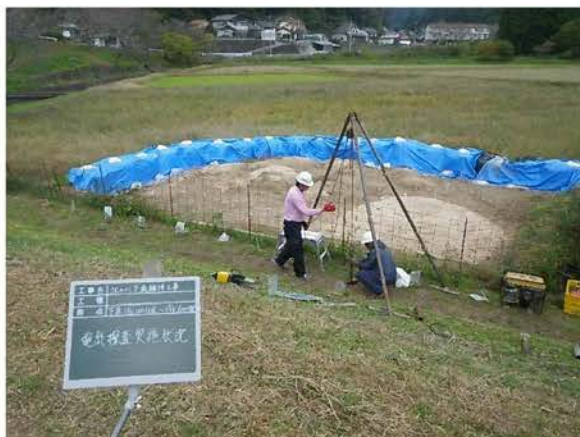
写真-3 牽引式電気探査
