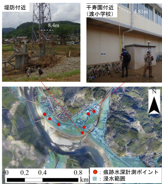
図-2 痕跡水深計測ポイントおよび現地の様子
