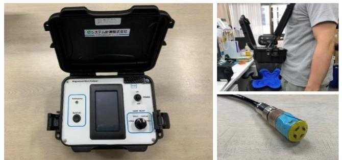
写真1 磁歪式応力測定装置
