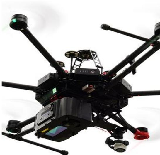
図-1 レーザスキャナ搭載ドローンの概観
