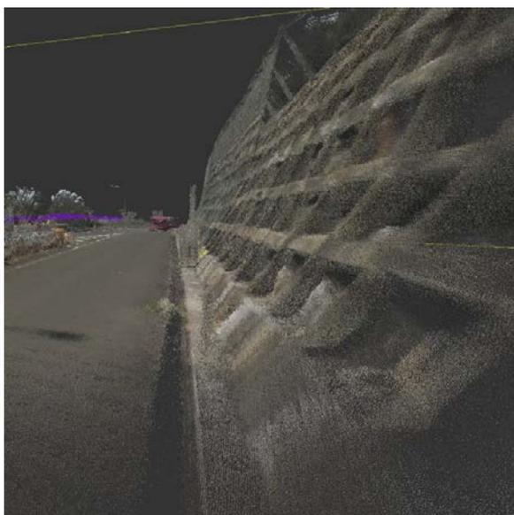
図-6 法面の3次元形状の復元結果
