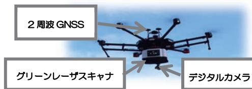
図 1 ドローンへの各種機器の装着図
