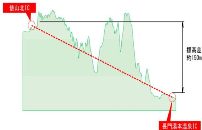
図-2 長門・俵山道路 縦断概要図
