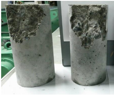
図5 供試体の破壊形状
