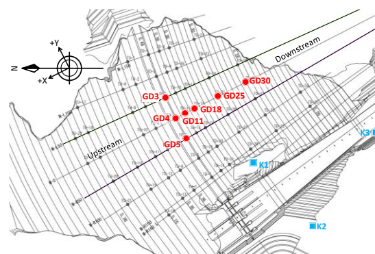
図-1 対象ロックフィルダムの平面と GPS センサ配置
