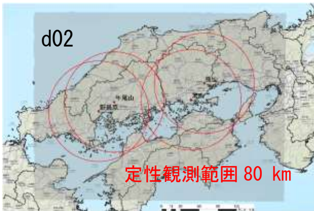
図-4 データ同化に用いた X バンド MP レーダの位置関係
