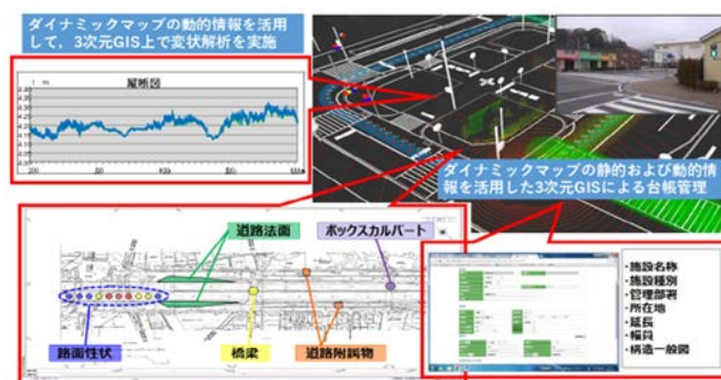
図-4 3次元道路インフラ維持管理システムの概念
