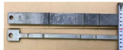
写真-2 小型試験機で使用したストリップ (上：幅 30mm、下：幅 10mm)
