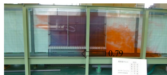
写真 3 傾斜板上段 20mm・中段 20mm・下段 20mm, 格子あり, ピットなしの実験結果
