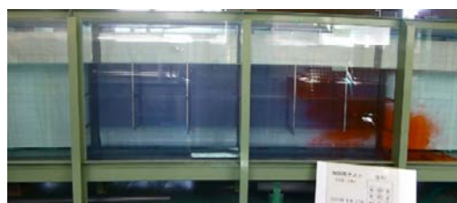
写真 7 傾斜板上段 20mm・下段 20mm (2 段 2 連), 格子なし, ピットありの実験結果 (流入直後)
