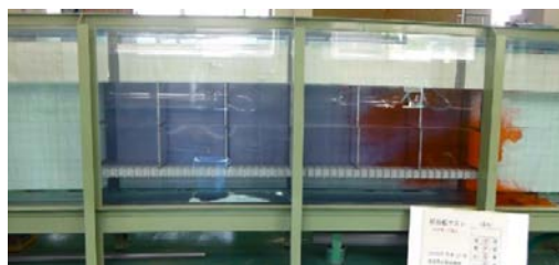
写真 8 傾斜板上段 20mm・下段 20mm (2 段 2 連), 格子あり, ピットありの実験結果 (流入直後)
