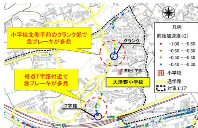
図-4 急減速発生状況
