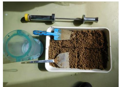
写真-5 締固め用具
