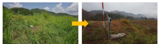
図-13 肩1地上センサを設置している単管パイプの延長前後の様子
