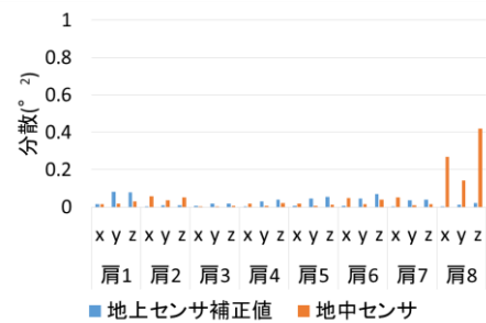
図-12 肩地上センサの補正值と地中センサの傾きの分散
