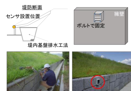
図-8 擁壁センサ設置方法
