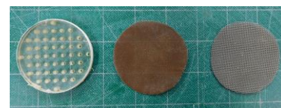
写真-1 アクリル板とメッシュ (左からアクリル板、250 \mu\text{m} メッシュ、420 \mu\text{m} メッシュ)
