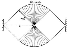
Fig. 1 Michell の最適構造概念 (1904)
