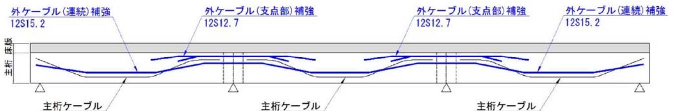
図-3 外ケーブル配置の概略図（側面）
