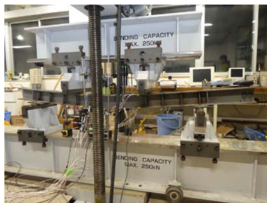
写真-2 曲げ載荷試験
