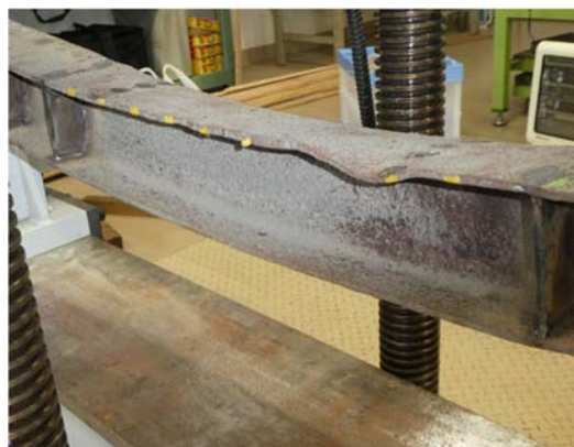
写真-3 上フランジの座屈形状(供試体 B)
