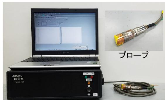
図1 磁歪式応力測定装置
