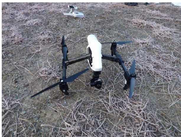
図-3 赤外線サーモグラフィを搭載し UAV
