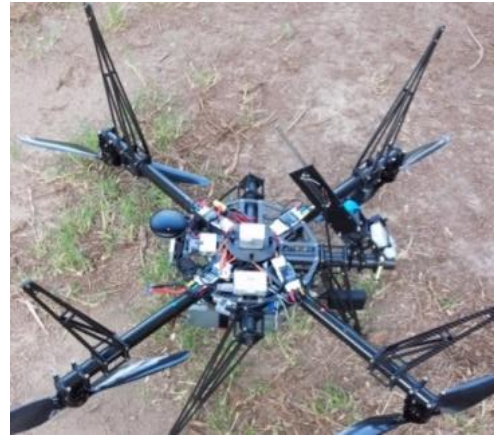
図-3.1 遠隔打音検査用UAV
