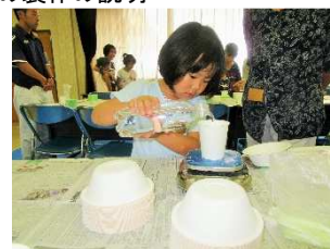
(2) 石膏・水の質量計測（1:0.6）
