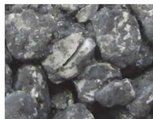
写真-1 凍結融解作用による石灰石のひび割れ
