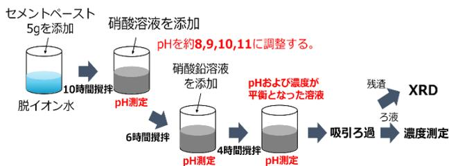
図1 吸着試験のフロー(液固比による pH 調整)
