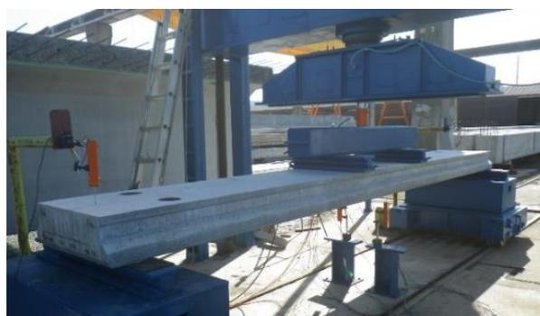
写真-1 載荷試験の状況
