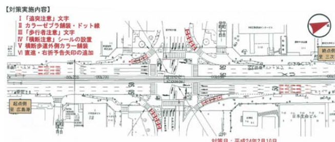
図1 白神社前交差点での交通事故対策状況 (出典 国土交通省 中国地方整備局)
