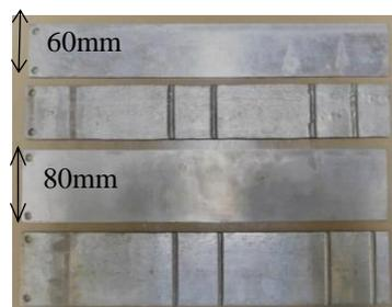
写真-1 リブ付きおよび平滑ストリップ
