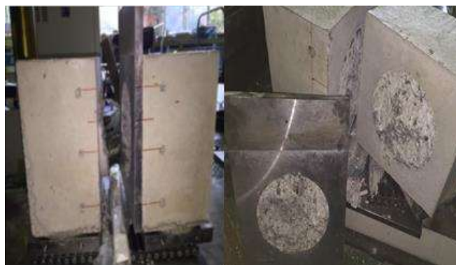
Fig.4 载荷後の供試体写真 (左：一面せん断破壊、右：二面せん断破壊)
