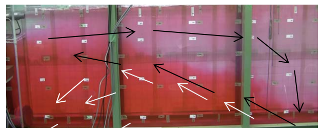
写真1 成層破壊の様子（装置稼働25秒後）
