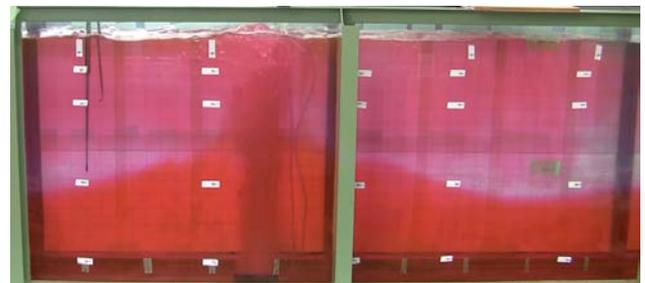
写真3 成層破壊・緩和の様子（曝気装置）
