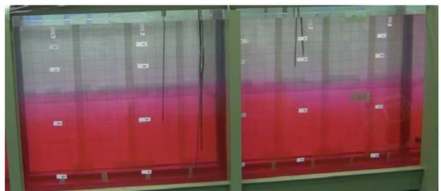
写真 1 成層破壊・緩和の様子(混合管無し)
