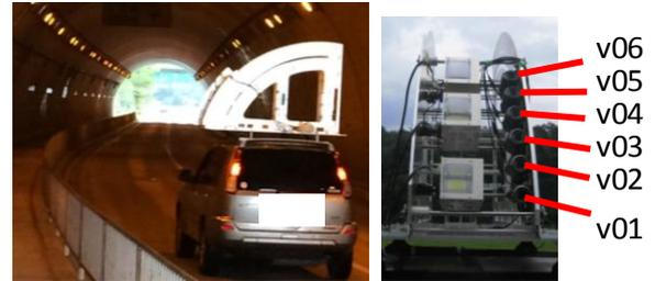
図1 トンネル壁面撮影装置
