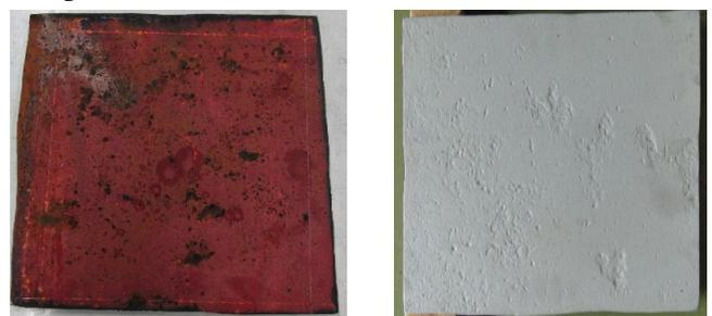
Fig.3.1 除錆前後の供試体の様子
