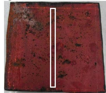
Fig.2.2 1つの評価点を取る範囲 (1mm×300mm)
