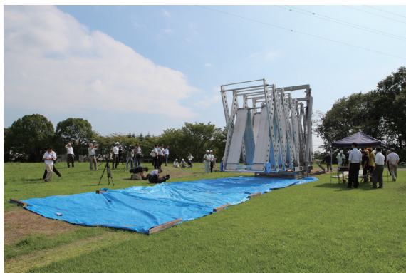
写真-2 折り畳める可搬展開橋「モバイルブリッジ (MB)」(2013.9.12 施工総研にて公開実験)
