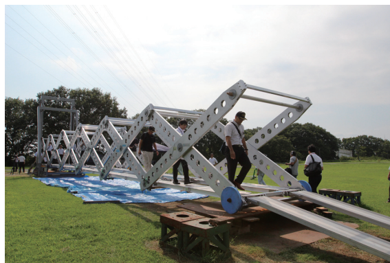
写真-2 折り畳める可搬展開橋「モバイルブリッジ (MB)」(2013.9.12 施工総研にて公開実験)
