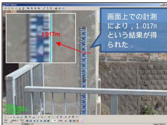
図8 量水標の計測状況
