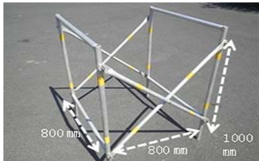
写真-1 土嚢袋支え治具
