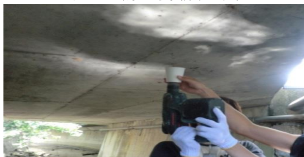
写真-1 ドリルによる試料採取状況
