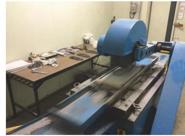
写真-1 往復チェーン型ラベリング試験機
