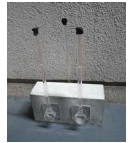
写真-4 吸水試験状況
