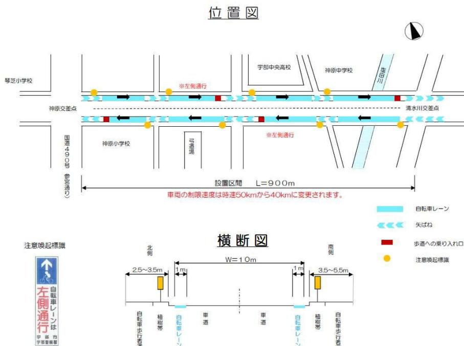
図3 自転車レーン位置図と横断面(宇部市 HP より引用)
