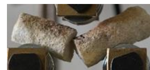
図-3 サンゴ礫の破壊状態
