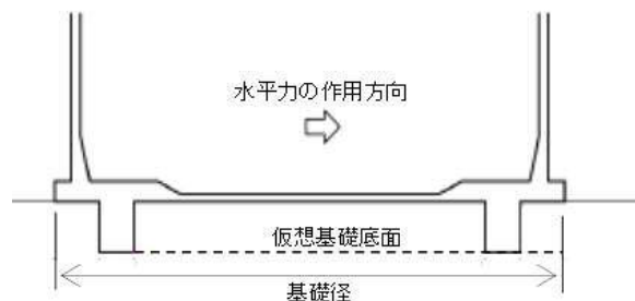
図-4 仮想基礎底面の模式図
