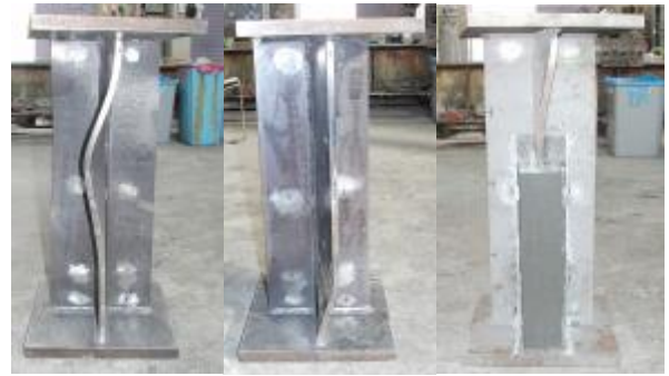
Fig.3 破壊性状 (左から、無腐食・無補修・補修供試体)
