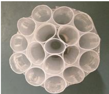
図-3 ハニカム構造体断面
