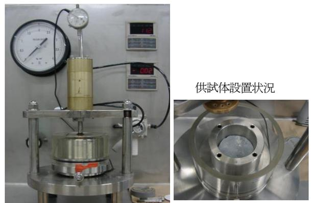
図-1 一次元膨潤圧測定試験装置 (模式図) および写真<sup>1)</sup>
