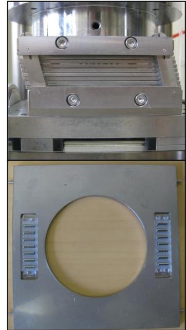
写真-1 せん断箱および積層板
