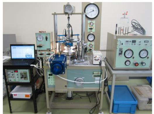
写真-3 圧密・定体積繰返し載荷リングセン断試験機
