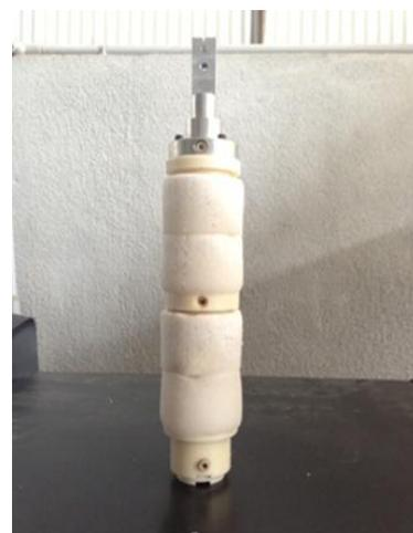
図-1 ペーパーディスク型地下水流向流速計本体
